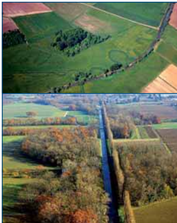
Figure 21 : Exemples de rescindements de méandres à vocation principalement agricole : en haut l'Orain (39), en bas l'Aire (Suisse). ≈
