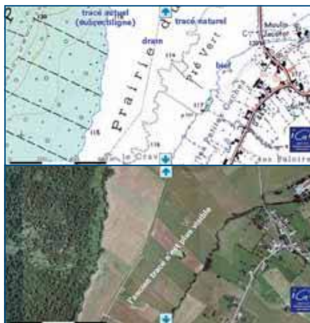
Figure 19 : Exemple de déplacement complet de cours d'eau : l'Armanche (10). Notez que les anciens méandres sont visibles sur la carte (illustration du haut) car ils ont servi de base à la délimitation de la frontière communale. Ils ne sont quasiment plus identifiables sur le terrain (illustration du bas) (source : Géoportail, IGN). 🌊
