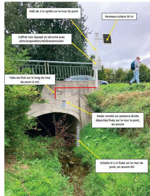
Exemple de schéma de principe d'une station de mesure- Station ST6
